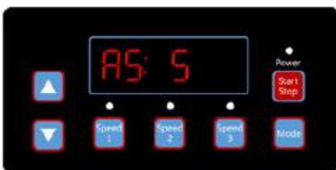
(Diagram 6.27, automatisk Start nedräkning, 5 sekunder kvar)
