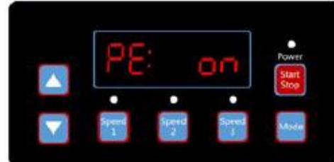
(Diagram 6.21, självsugande tid, standard 2 minuter)
