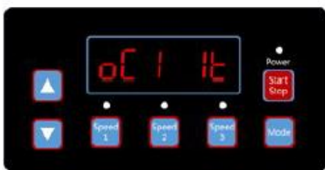
(Diagram 6.25, automatisk återställning, felinformation OC1, fel tid 1)
