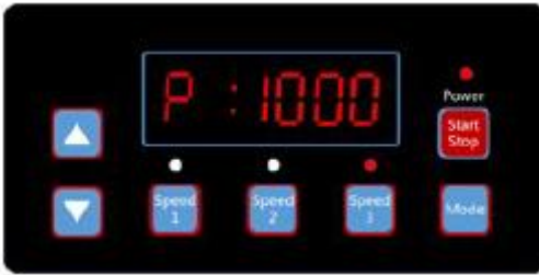
(Diagram 6.9, strömförbrukning display, hastighet 3)
