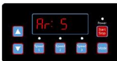
(Diagram 6.26, automatisk återställning räkna ner, 5 sekunder kvar)
