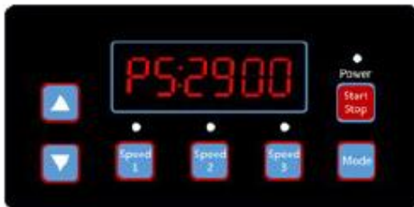
(Diagram 6.22, självsugande hastighet, standard 2900rpm)
