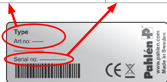
Пример заводской таблички (80x30 мм).
